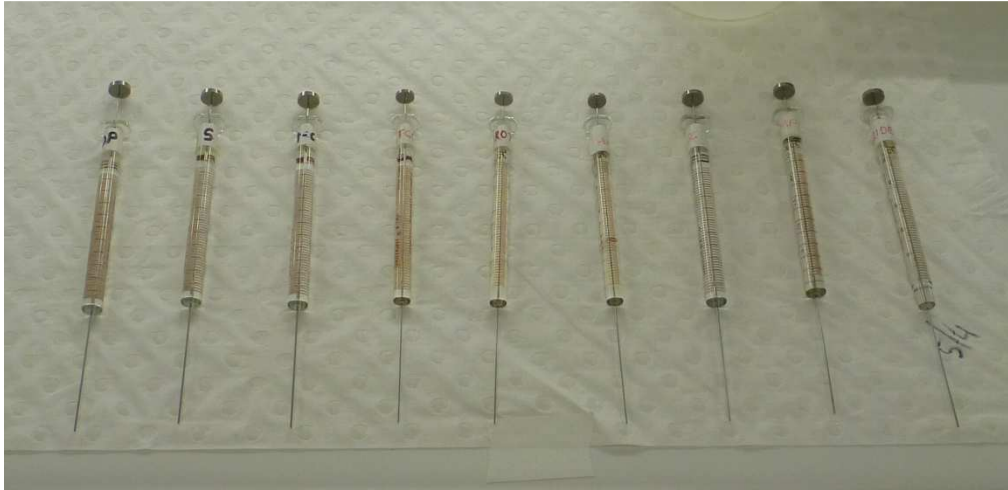
Image 9 : Ensemble des seringues nécessaires à l'ajout des substrats dans les chambres de mesure de la respiration mitochondriale.
