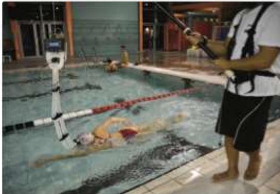
**Photo 1.** Système portable Aquatrainer pour la mesure en direct de la consommation d'oxygène en natation (Cosmed).
