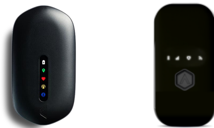
Figure 9 : Deux des unités GPS les plus utilisés actuellement dans le football professionnel (clubs et fédérations) avec une fréquence d'échantillonnage à 10 Hz et la double constellation (GPS + GNSS). A gauche, le Vector S7 de Catapult et à droite, le Apex Pro Series Pod de STATSport.
